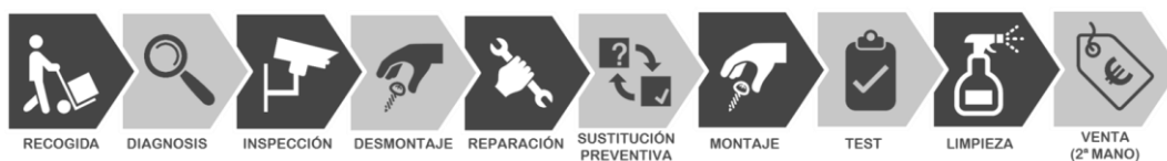
Figura 6.- Procesos necesarios para el reacondicionamiento de un producto
